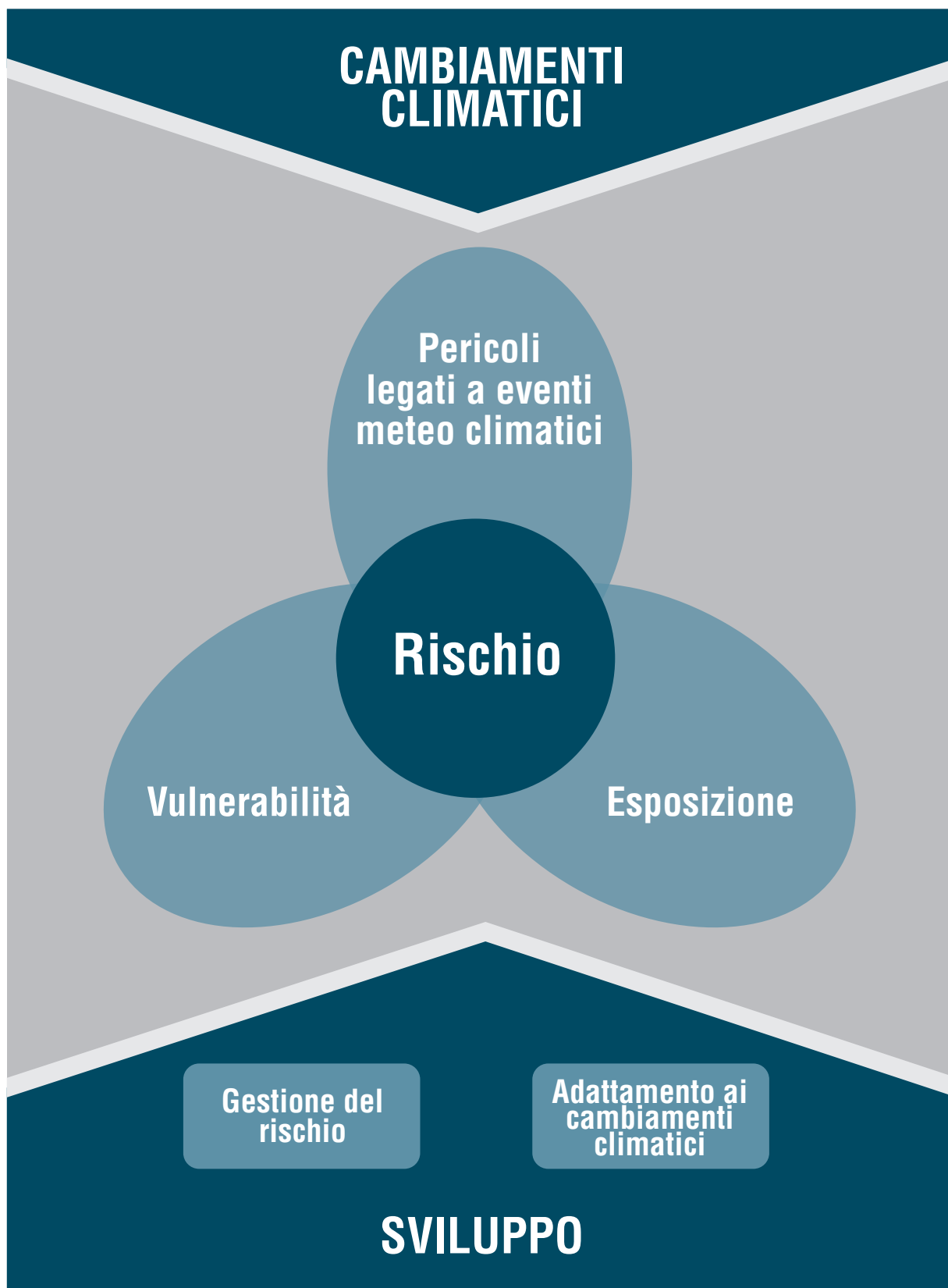
Figura 17. Il rischio da cambiamenti climatici, come definito e illustrato nel Quinto Rapporto di Valutazione dell'IPCC (IPCC, 2014), deriva dall'interazione di vulnerabilità, l'esposizione e pericolosità. Elaborazione grafica: Fondazione CMCC.
